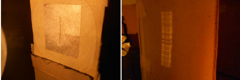
Imágenes del filamento obtenidas con una serie de orificios en sucesión vertical.
